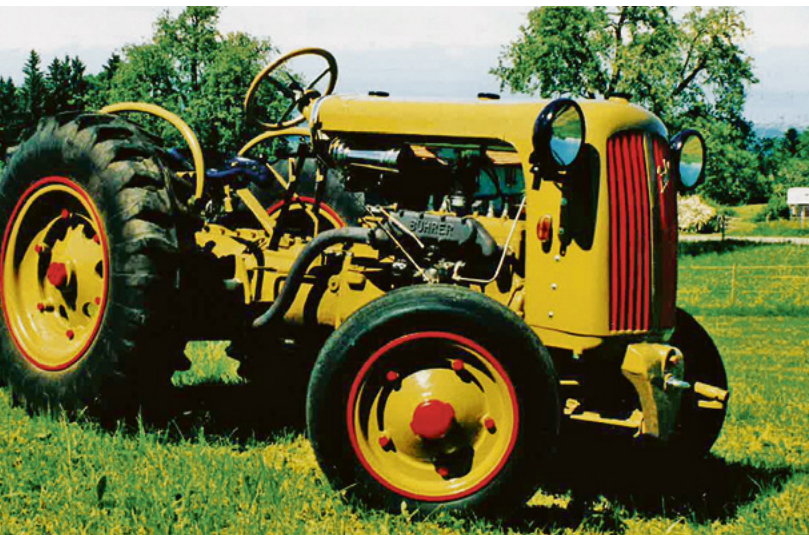
Ein Bühler BJ4 (Junior) mit Dreiganggetriebe. Diese neue Serie ab 1937 verfügte bereits über eine Hinterachssperre.
