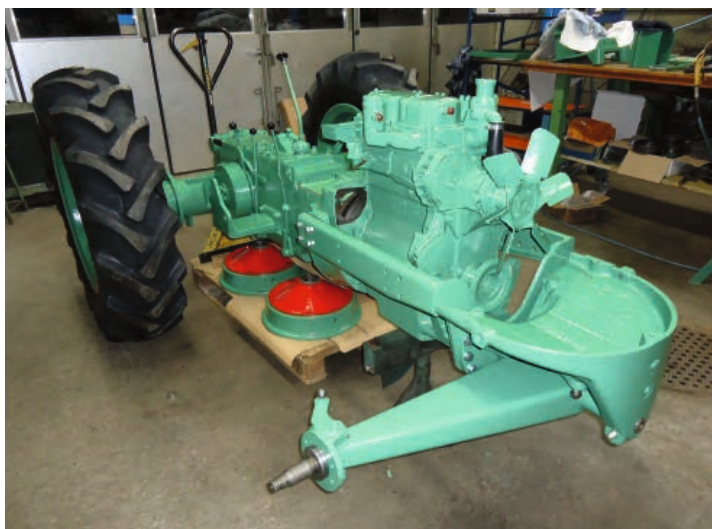
Der Bührer LP3 wurde komplett zerlegt und restauriert.
