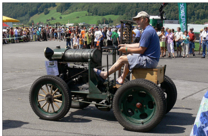
Ein Bühler des Typs A mit seitlichem Mähbalken (Jhg. 1930). Der Traktor ist im Besitz von Ernst Künzli, Abtwil AG.
