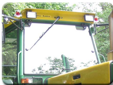
Die Scheibenwischanlage, die das Regenwasser von der grossen Frontscheibe verdrängt (optional mit Scheibenwaschanlage ausrüstbar)
