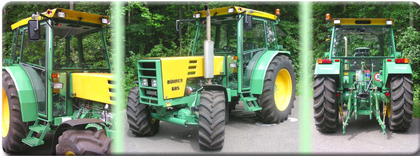
Ein Bührer 685 der mit einer Sicherheitskabine R50X ausgerüstet ist
