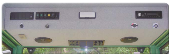
Die Bedienelemente der Viktor Sicherheitskabine R50X sind am Kabinendach angeordnet (inklusive Heizung und Lüftung)
