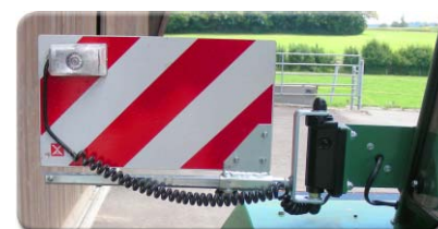
Doppelbereifungssignalisation mit Beleuchtung für die Dunkelheit
