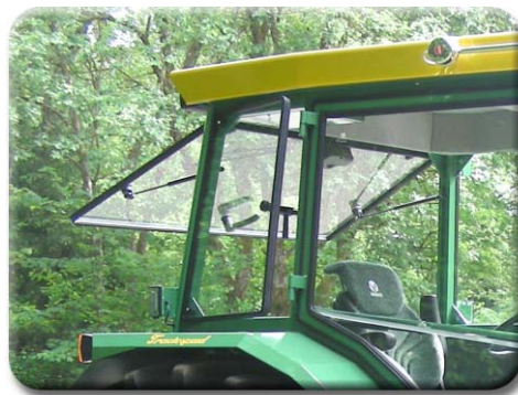
Das offene Seitenfenster und das mit Gasdämpfern offen gehaltene Heckfenster (eine Heckscheibenwisch-/waschanlage ist optional)
