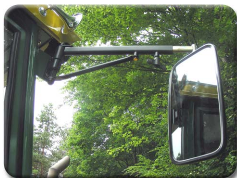
Einer der 2 grossen, solid und schwenkbar befestigten Aussenrückspiegel, die eine gute Sicht nach hinten ermöglichen
